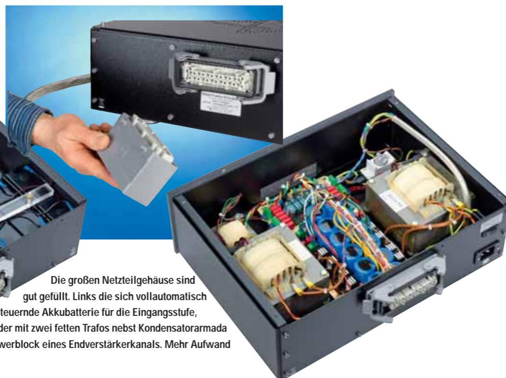
Die großen Netzteilgehäuse sind gut gefüllt. Links die sich vollautomatisch steuernde Akkubatterie für die Eingangsstufe, rechts der mit zwei fetten Trafos nebst Kondensatorarmada bestückte Powerblock eines Endverstärkerkanals. Mehr Aufwand geht nicht
